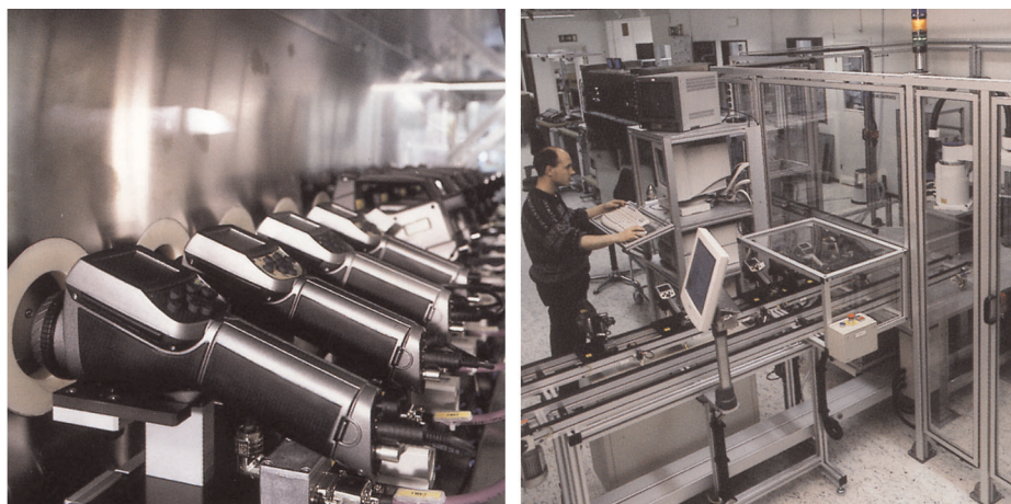
图 11.5 左图：在气候箱中测试红外热像仪；右图：用于热像仪测试和校准的机器人
