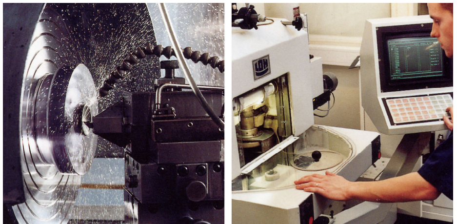
图 13.4 左图：金刚石车削机床；右图：镜头抛光
