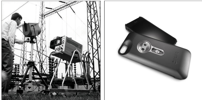
图 13.2 左图：Thermovision 661 型诞生于 1969 年。这款热像仪重量大约在 25 千克左右，示波器重 20 千克，三脚架重 15 千克。操作员还需要一个 220 VAC 的发电机组，以及一个装有液氮的 10 升液罐。在示波器的左边，可以看见 Polaroid 配件（6 千克）。右图：FLIR One 2014 年 2 月推出，是一款滑动式附件，为 iPhone 提供了热成像功能。重量为 90 克。
