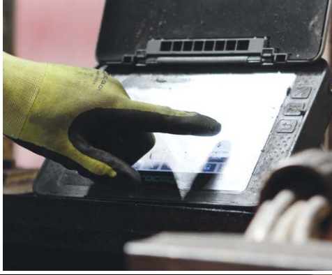
减震、防尘和防水 (IP 54) 坚固外壳
