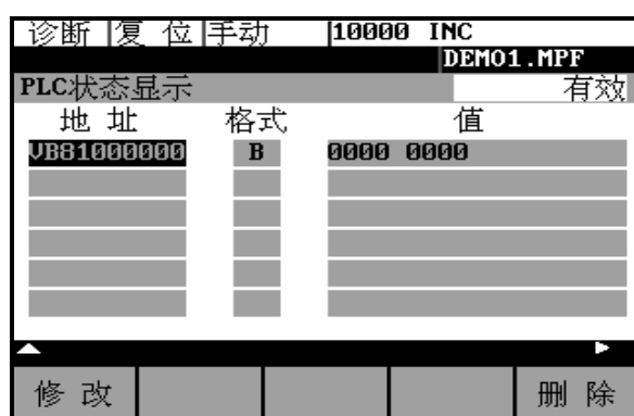
图 7-17 PLC 状态显示
