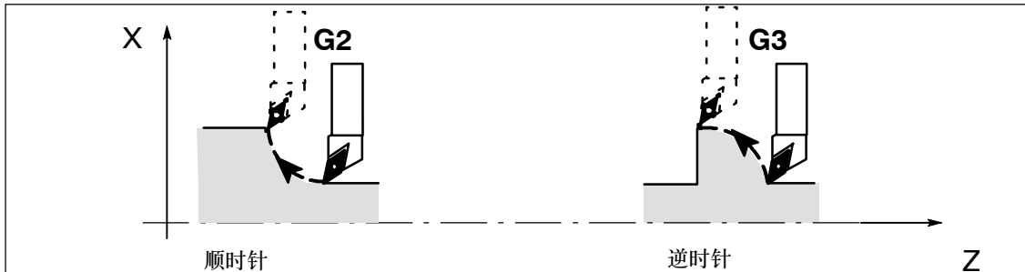
图 8-11 确定圆弧方向 G2/G3
