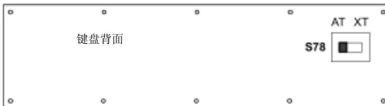
用开关 S78 可以在 AT 方式 (供货状态) 和 XT 方式之间进行转换。
