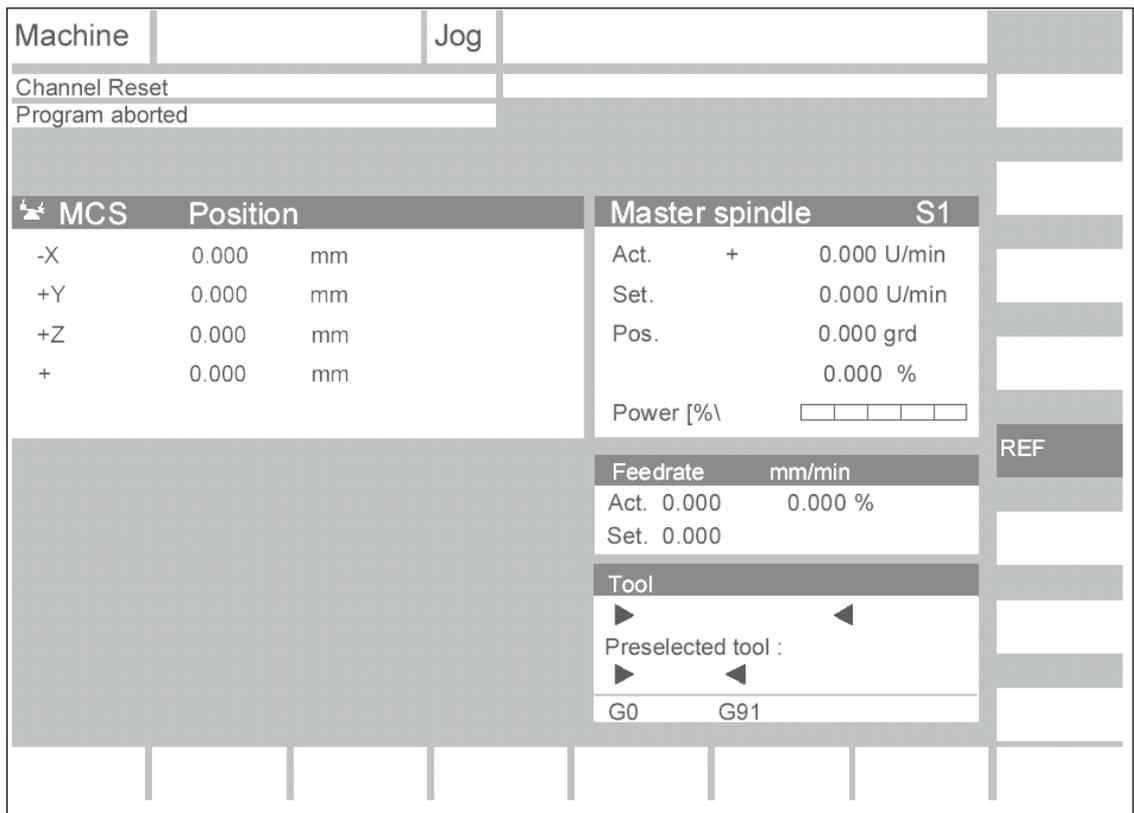
图 2-2 PCU 成功启动后屏幕显示内容
