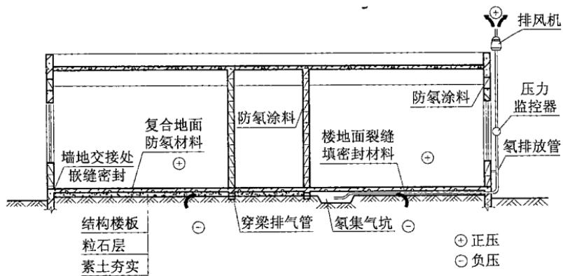
图 D. 0. 5 土壤降压法系统图
