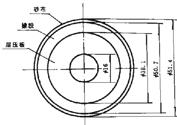
注：研磨轮内圈是纸质或布质层压板制成，厚度为 $12.7\text{ mm}\pm0.2\text{ mm}$ ，直径为 $38.1\text{ mm}\pm0.2\text{ mm}$ ，中心有一直径为 $16.0\text{ mm}\pm0.4\text{ mm}$ 的孔，外包一层肖氏硬度为 $50\sim55$ 的橡胶层（橡胶硬度为国际橡胶硬度标度），宽为 $12.7\text{ mm}\pm0.2\text{ mm}$ ，厚度为 $6.3\text{ mm}$ ，用氯丁橡胶粘于内圈上，最外圈是纱布。最终研磨轮直径为 $51.4\text{ mm}\pm0.6\text{ mm}$ ，轮的质量为 $27\text{ g}\pm2\text{ g}$ 。
