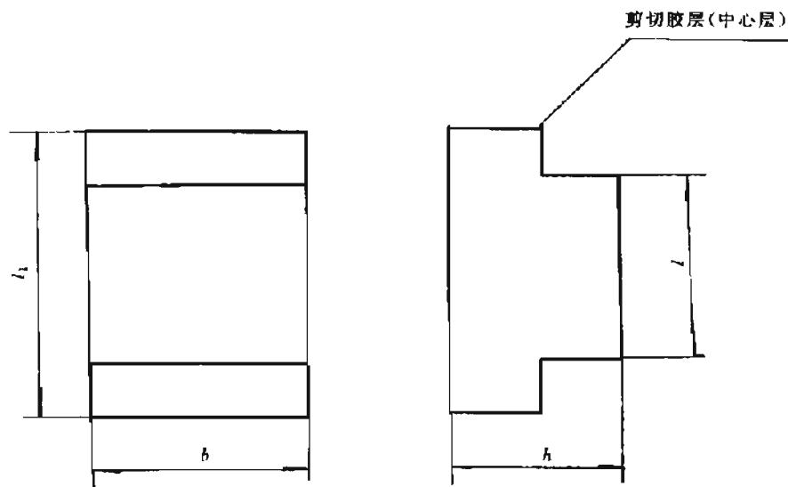
图 22 胶层剪切强度试件图
