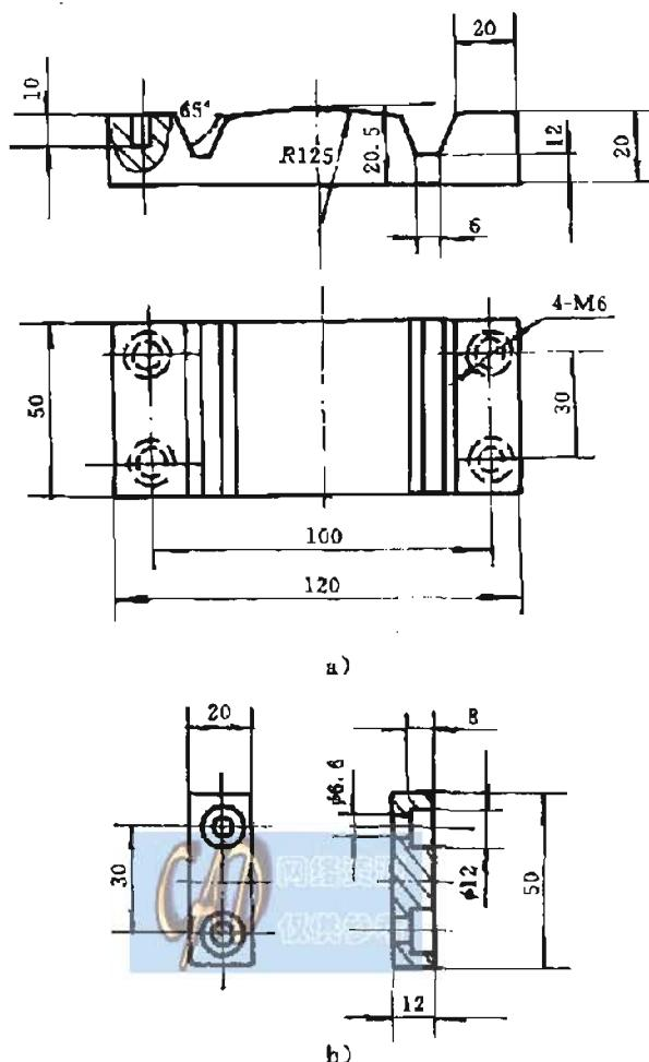
图 38 耐开裂试验用钢质夹具
