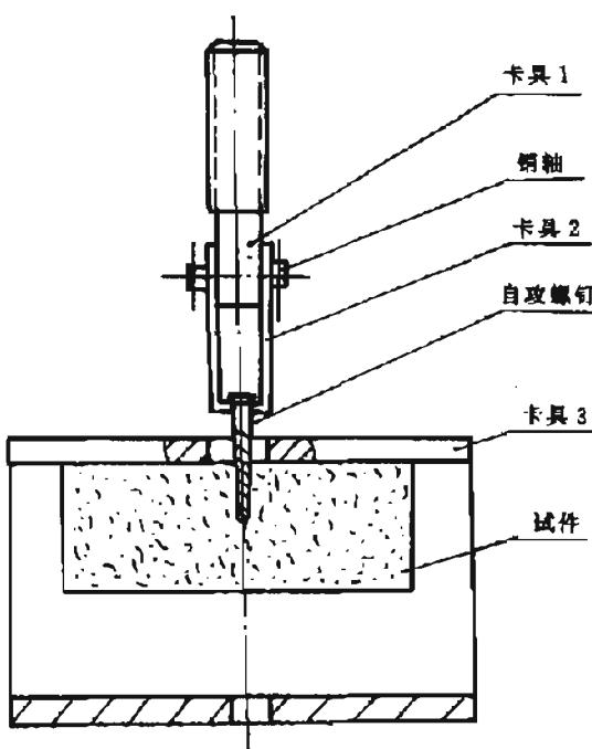
图 8 捏螺钉力测定示意图
