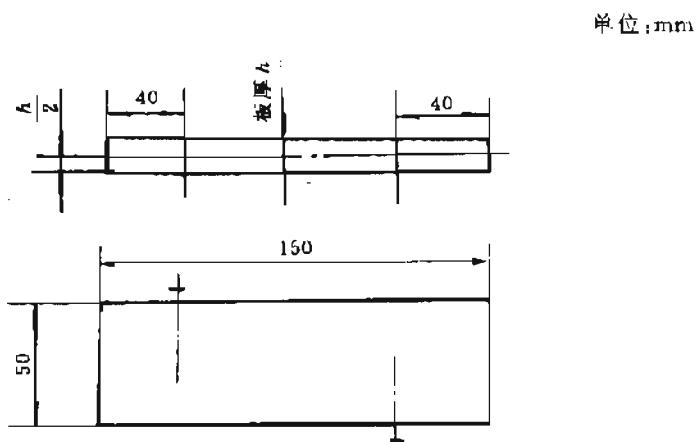
图 13 板边握螺钉力示意图
