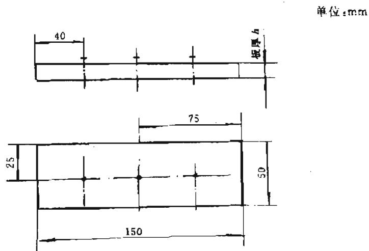
图 12 板面握螺钉力示意图
