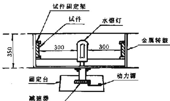
图 29 旋转式鼓室灯照装置示意图
