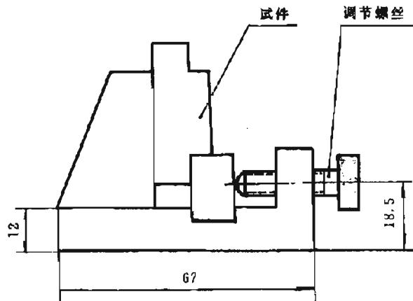
图 23 胶层剪切强度测试图
