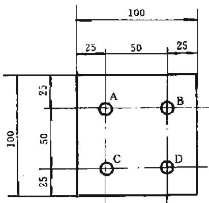
图 2 试件厚度测量位置图
