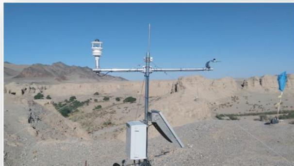
2016 年 9 月华益瑞为张掖气象局，设计调试安装了风能监测系统、梯度气象监测系统及涡动相关系统。其中风能系统和梯度气象监测系统共同安装在 100 米的高塔上，涡动相关使用 3 米的三角支架作为载体进行安装。
