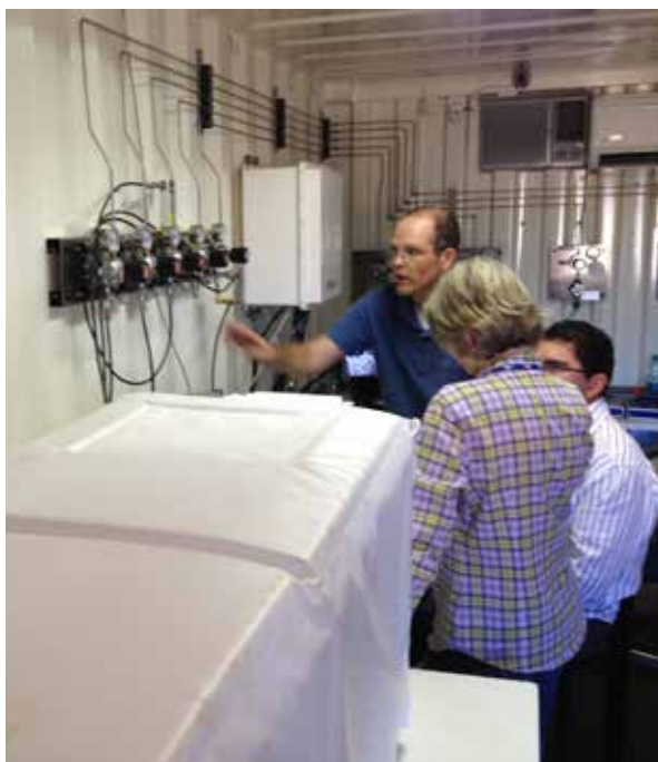
应用案例四：巴西，农田不同作物 \text{N}_2\text{O} 通量测量，TGA200安装在集装箱里，周围有4个采样点，每点上下两层进气口来计算 \text{N}_2\text{O} 通量，同时使用CSAT3和热线热电偶测量感热通量
