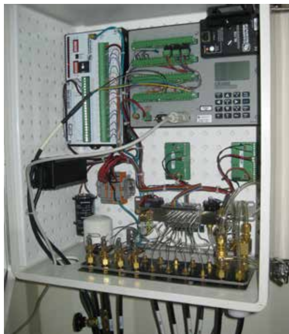
应用案例四：巴西，农田不同作物 \text{N}_2\text{O} 通量测量，TGA200安装在集装箱里，周围有4个采样点，每点上下两层进气口来计算 \text{N}_2\text{O} 通量，同时使用CSAT3和热线热电偶测量感热通量
