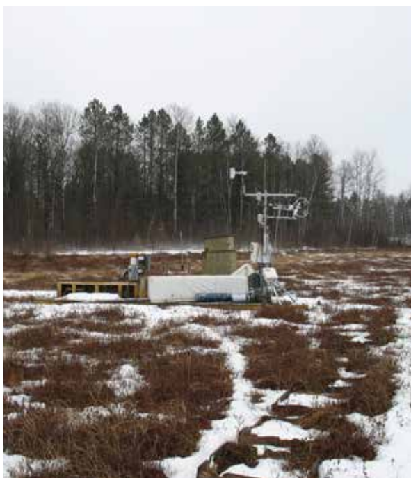
应用案例三：美国明尼苏达，用来测量 \text{CH}_4 和 \text{CO}_2 通量使用TGA100A、CSAT3及其他传感器
