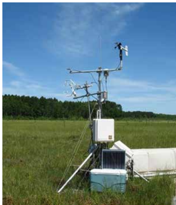
应用案例三：美国明尼苏达，用来测量 \text{CH}_4 和 \text{CO}_2 通量使用TGA100A、CSAT3及其他传感器
