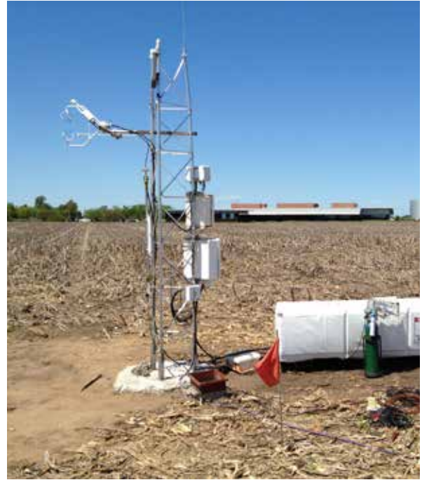
应用案例一：阿根廷东北部用于玉米、大豆耕地的碳、氮、水交换研究（ N_2O ， CO_2 ， H_2O 涡动相关）使用TAG200A、CSAT3及其他常规传感器
