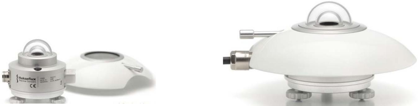
SR20 标准辐射表是一款最新的标准辐射表，设计用于测量太阳总辐射。传感器包括一个水平调节装置，一个水平泡和水平调节螺栓以及一个干燥器。SR20 标准辐射表是世界气象组织（WMO）二等标准辐射表，用于测量太阳和天空辐射，适应很宽的波长范围。它由一个组合热电堆电路组成，可以很好的抵抗机械震动和打击。传感器的接收器上有一层黑漆，底部为一个半球形玻璃顶罩。
