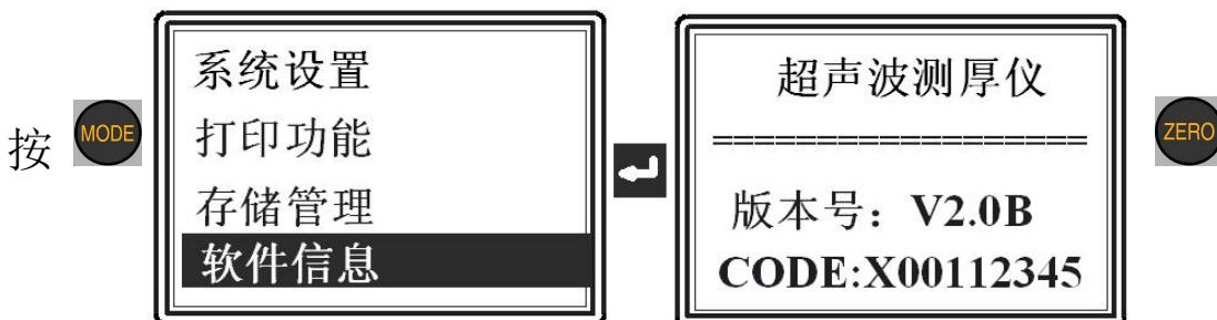
在软件信息的显示下按 键后仪器将恢复出厂设置的参数同时自动关机。
