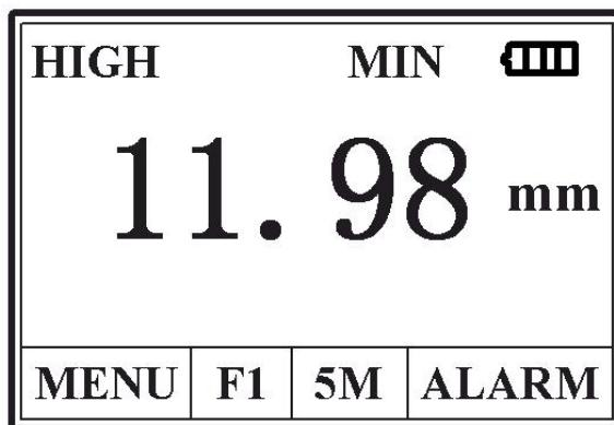
并且最小值标志 **MIN** 闪烁几秒，如果在 **MIN** 闪烁期间继续测量，前面的测量值将继续参加最小值捕捉，**MIN** 停止闪烁后再进行测量，重新进行最小测量值捕捉。
