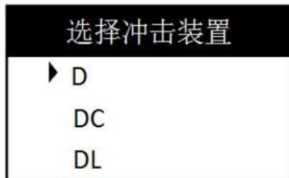
**注意：**在强度测量模式，冲击装置不可选择，测量强度时只能使用D型冲击装置。
