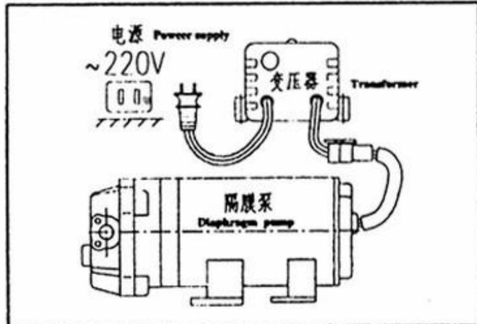
1、DP系列隔膜泵采用12V或24V的永磁直流电动机，用户千万不要直接使用220V电源，若直接插入220V的电源，电机即刻烧坏。本公司备有各类型的变压器，若用户无系统变压设备，可增购适用变压器，以使隔膜泵正常运转。
