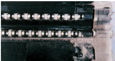
钢球滚动面上没有发现异物的落入
