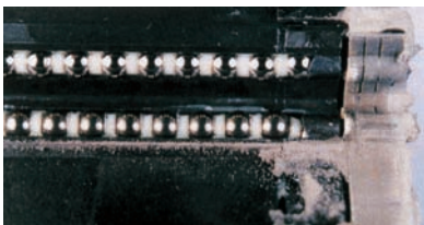
钢球滚动面上没有发现异物的落入
