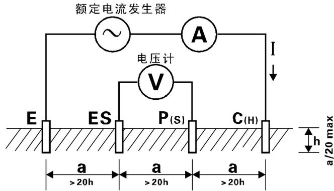
5. 二三四线直流电阻测试采用额定电流变极法(适合测量等电位连接电阻测试), 即在测量对象  $R$  之间流动直流额定电流  $I$ , 求取  $R$  两端的电位差  $V$ , 并根据公式  $R=V/I$  计算接地电阻值  $R$ 。为了保证测试的精度, 采用 4 线法, 增加 **ES 辅助地极**, 实际测试时 **ES** 与 **E** 夹在被测物的同一点上。
