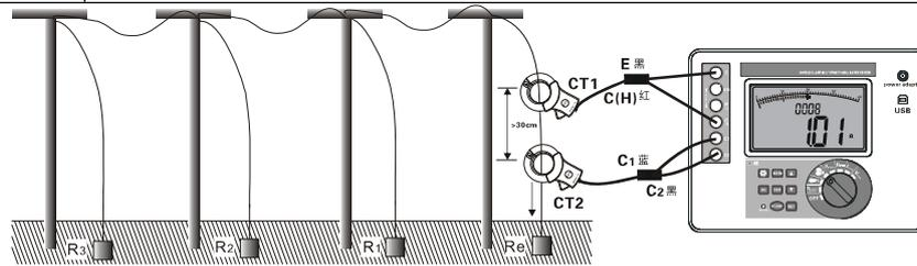
连接好测试线后，先将 **FUNCTION** 功能选择旋钮旋至“
