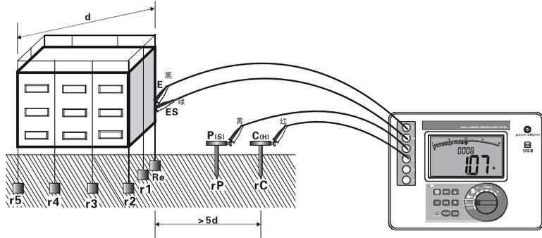
$$R=r1 // r2 // r3 // r4 // r5 // r6 // \dots // m(r1 \dots m \text{ 都是独立接地点})$$
