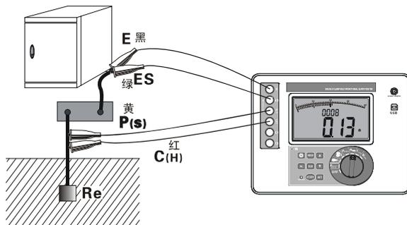
连接好测试线后，先将 **FUNCTION** 功能选择旋钮旋至 “**R $\infty$** ” 位置，进入直流电阻测试模式，按一下 “**START**” 键开始测试，测试过程中有倒计时指示及测试进度棒图指示，测试完毕后显示稳定的数据，即被测设备与接地体等电位的联结电阻值 **R**。
