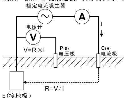
2. 选择法测量接地电阻值测量采用电流变极法(适用于不解扣测量并联接地系统的其中一个地网接地阻值), 在 **Re1 Re2 Re3** 接地极和 **C(H)** 电流极之间施加交流电流 **I**, 通过 **CT2** 测量出流经 **Re3** 的电流 **I3**, 同时测出 **Re3** 接地极和 **P(S)** 电压极的电位差 **V**, 并根据公式  $Re3=V/I3$  计算接地电阻值 **Re3**。为了保证测试的精度, 采用 4 线法, 增加 **ES 辅助地极**, 实际测试时 **ES** 与 **E** 夹在接地体的同一点上。
