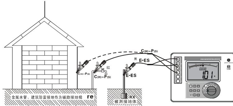
简易法测量接地电阻，其仪表读数为被测接地体的接地电阻值与商用接地体的接地电阻值之和，即：
