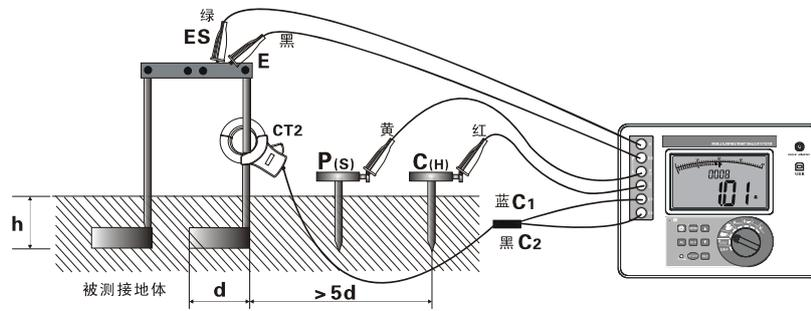
连接好测试线后，先将 **FUNCTION** 功能选择旋钮旋至 “ $R_e$ ” 位置，进入接地电阻测试模式，按一下 “**START**” 键开始测试，测试过程中有倒计时指示及测试进度棒图指示，测试完毕后显示稳定的数据，即上图中左边被测接地体的接地电阻值  $R$ 。
