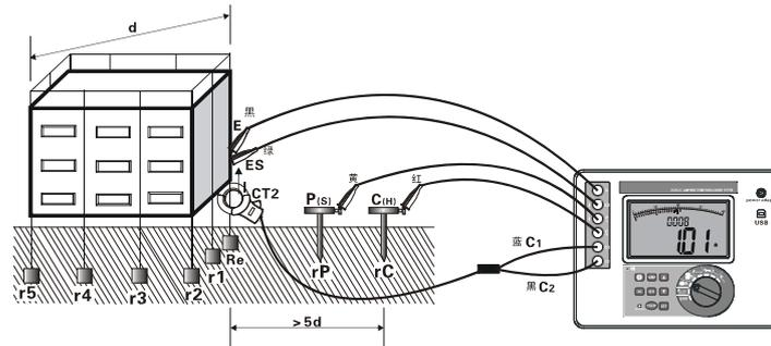
对于多点独立接地系统或较大型的地网，可以选配 50m 或更长的测试线进行测试，如下图：测量结果为  $R_e$  的接地电阻值，不受  $r_1$ 、 $r_2$ 、 $r_3$ 、 $r_4$ 、 $r_5$ ... 接地电阻值的影响。
