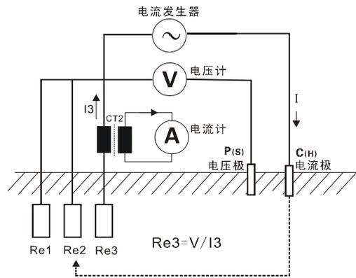
3. 双钳法测量接地电阻值(适用于多独立点并联接地系统不打辅助地桩测量), 通过激励钳 **CT1** 产生一个交流电动势 **V**, 在交流电动势 **V** 的作用下在回路中产生电流 **I**, 再通过 **CT2** 检测到反馈的电流 **I**, 并根据公式  $R=V/I$  计算出电阻值, 图中  $R=R_e+R_1//R_2//R_3//\dots R_{n-1}//R_n$ , 当  $R_1//R_2//R_3//\dots R_{n-1}//R_n$  (多个接地点并联后的阻值) 远小于  $R_e$ , 有  $R \approx R_e$ 。
