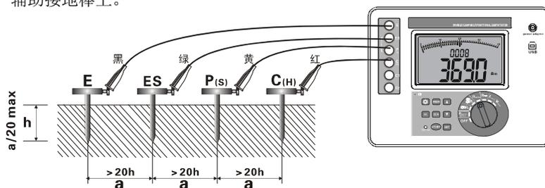
根据温纳法确定测量土壤电阻率的值约为两个接地棒间的距离  $a$  深度处的土壤电阻率,可通过改变  $a$  值来检查土壤均质性,从而设计合适的接地电极。
