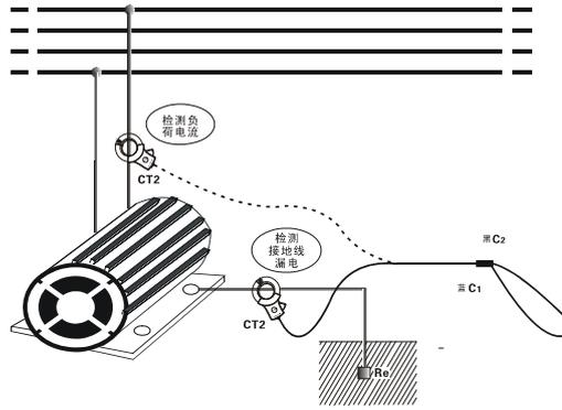
连接好电流钳后，先将 **FUNCTION** 功能选择旋钮旋至 “Iclamp” 位置，进入电流测试模式，LCD 直接显示电流有效值，同时棒图指示幅值变化。
