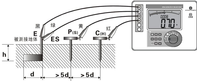
对于多点独立接地系统或较大型的地网，可以选配 50m 或更长的测试线进行测试，如下图：
