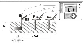
对于多点独立接地系统或大地网接地系统,用户自行选用更长的测试线即可, 电极间距大于被测试地网最大对角线长的 5 倍即可。如下图:
