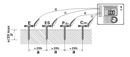
设定完 a 值后,在土壤电阻率测试模式下,按"START"键开始测试,并倒计数显示测试进度,完成测试后显示稳定的土壤电阻率值。
