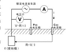
之间的接触电阻(通常有污垢或生锈)对测量的影响,能消除线阻对测量的影响,更精密。
