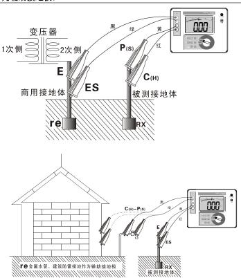
二线简易法测量接地电阻,其仪表读数为被测接地体的接地电阻值与商用接地体的接地电阻值之和,即:
