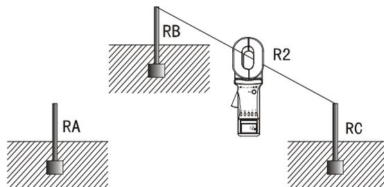
第三步，将 RC 和 RA 连接起来，见下图。用钳表读得第三个数据  $R_3$ 。
