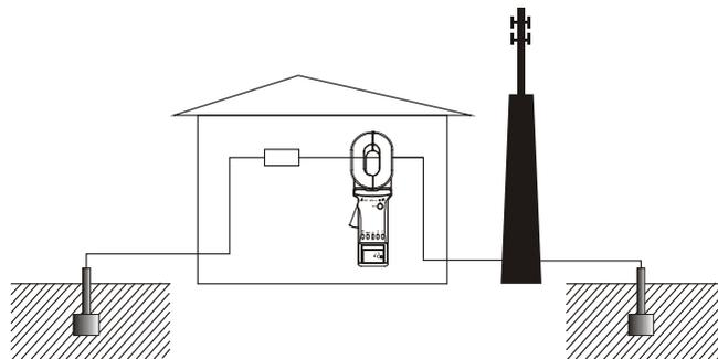
如果钳表的测量值小于接地电阻的允许值，那么机房、发射塔的接地电阻都是合格的。如果钳表的测量值大于允许值，请按单点接地进行测量。
