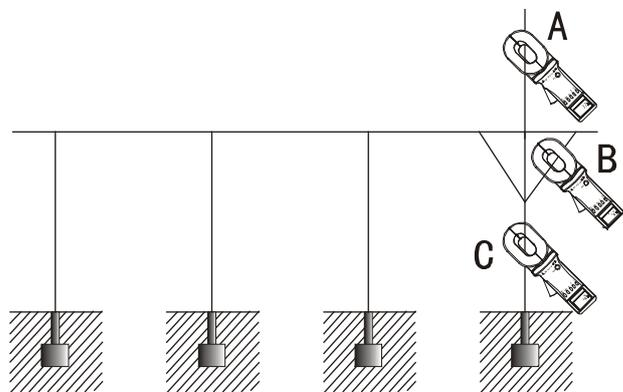
在 A 点测量时，所测的支路未形成回路，钳表显示“OL Ω”，应更换测量点。
