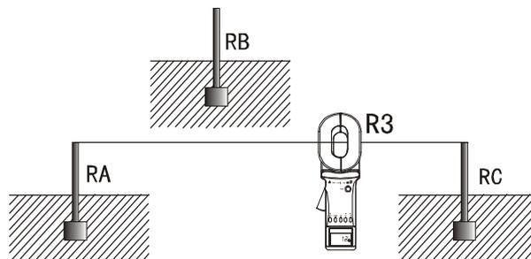
上面三步中，每一步所测得的读数都是两个接地电阻的串联值。这样，就可以很容易地计算出每一个接地电阻值：
