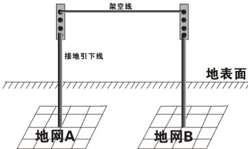
(2). 若仪表测试出的地网 A、地网 B 回路的综合值为 5 欧, 即:  $R_A+R_B+R_{\text{架空线}}+R_{\text{接地引下线}}=5.0\Omega$ , 那地网 A、地网 B 两个并联起来对地的实际接地电阻值一定小于等于  $2.5\Omega$ , 据此可以判断地网 A 并联了地网 B 后的实际接地电阻值是否合格。
