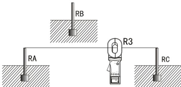
上面三步中，每一步所测得的读数都是两个接地电阻的串联值。这样，就可以很容易地计算出每一个接地电阻值：
