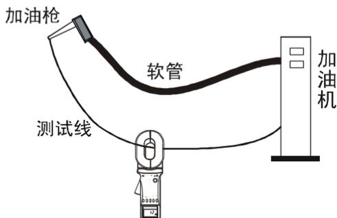
用一根测试线将加油枪和加油机连接起来。用钳表测出读数  $R_T$ 。则可计算出：加油机软管连接电阻为： $R = R_T - R_L$
