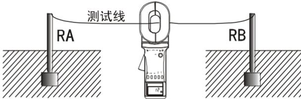
由于钳表所测的阻值是两个接地电阻和测试线阻值的串联值。
