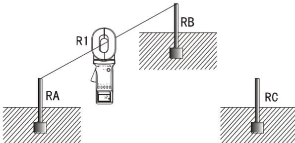
第二步，将 RB 和 RC 连接起来，见下图。用钳表读得第二个数据 R2。
