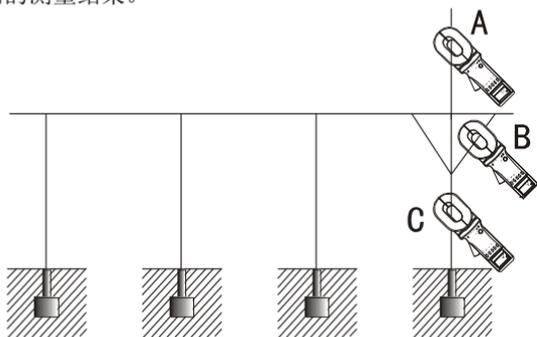
在 A 点测量时，所测的支路未形成回路，钳表显示“ $0L\Omega$ ”，应更换测量点。
