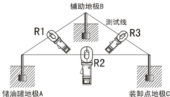
如上图，在加油站接地系统中，储油罐接地极 A 与加油机相连接，装卸点接地极 C 是一个独立的接地极。再找一个独立的接地极作为辅助接地极 B（如自来水管等），按三点法用钳表分别测出 R1、R2 和 R3。
