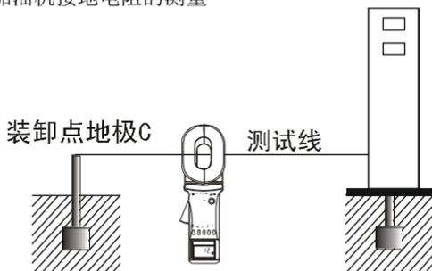
如上图，找一个与加油机接地极互相独立的接地极，如装卸点接地极等。用测试线将两点连接起来，用钳表测出读数  $R_T$ 。则可计算出：加油机接地电阻为：
