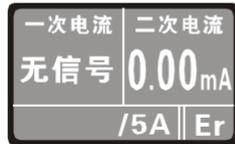
主机开机约 10 分钟后 LCD 持续闪烁，提示将自动关机，LCD 持续闪烁约 30 秒后自动关机，以降低电池消耗。若 LCD 持续闪烁时，按 **POWER** 键主机能继续工作。
