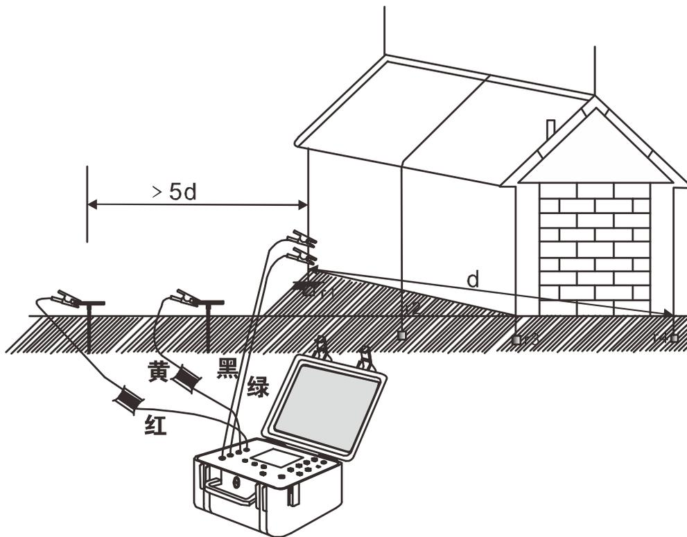
$R=r_1 // r_2 // r_3 // r_4 // r_5 // r_6 // \dots // r_n$  ( $r_1 \dots r_n$  都是独立接地点)
