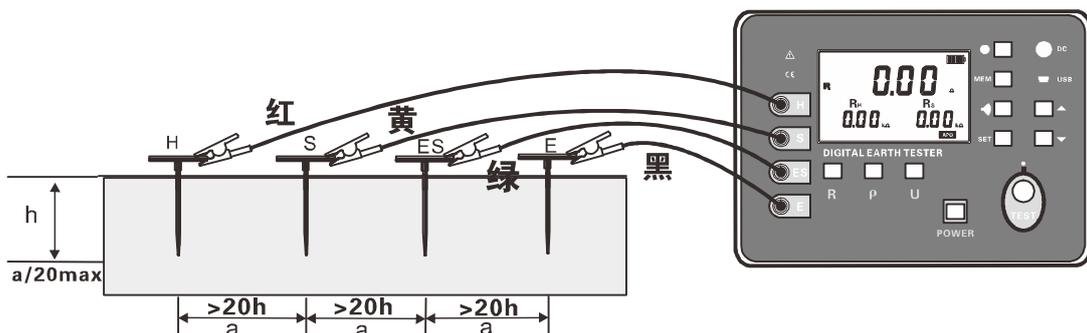
辅助接地棒的间距设置：连接好测试线后，开机按功能按键  $\rho$ ，进入土壤电阻率测试模式，长按“**SET**”键(超过3秒)进入辅助接地棒的间距设置，短按“ $\bullet$ )”键移动光标，按“ $\blacktriangle$ ”或“ $\blacktriangledown$ ”键改变当前数字大小(a值范围:1m~100m)，再长按“**SET**”键(超过3秒)保存设定的a值，并返回土壤电阻率测试模式。
