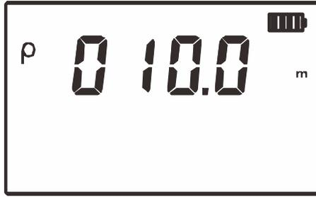
设定完a值后，在土壤电阻率测试模式下，按“**TEST**”键开始测试，并倒计时显示测试进度，完成测试后显示稳定的土壤电阻率值。
