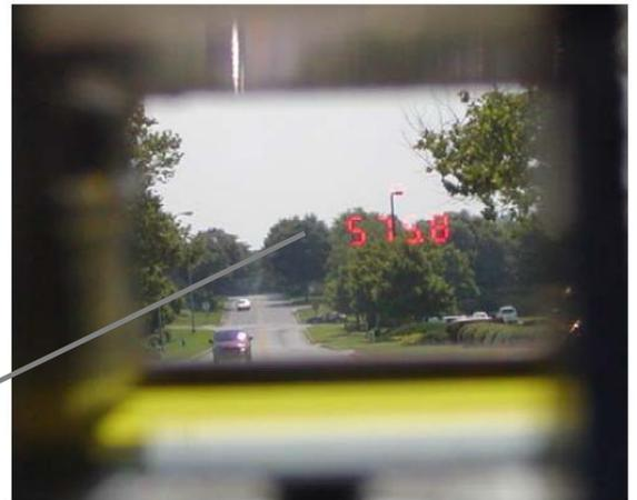
Contour XLRic 的 HUD 内提供微光瞄准镜，可方便的瞄准被测物体，测出离被测物体的距离
