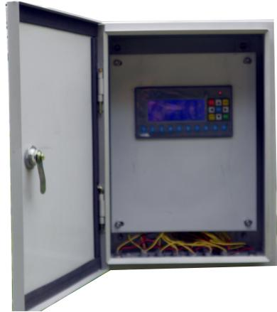
数据采集控制器由主控板、液晶显示器、按键和传感器接口等组成，装置于防水的金属壳体内。
