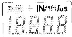
当 IN 和  $\mu s$  图标同时显出时，MX-3 屏幕上显示的声速值的单位为英寸/微秒。
