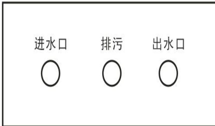
产品底部分别接进水管、排污管、出水管。
