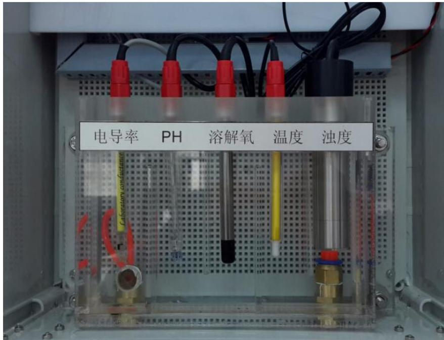
流通池配有:电导率电极、PH 电极、溶解氧电极、温度传感器、浊度传感器。
