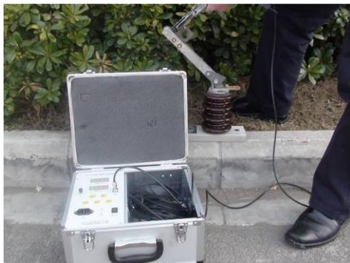
第三步 测量触指压力
