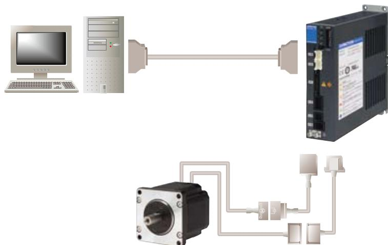
配备有从上位装置机到驱动器，及驱动器到电机的电缆和连接器。
