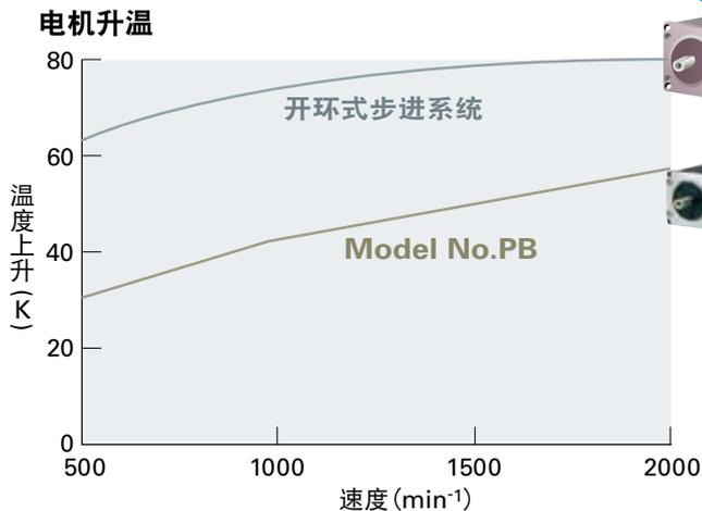
根据负载情况对通过电机的电流进行控制，从而可减少发热，提高效率。AC 电源输入系列的电机发热比以往产品降低了 60%。
