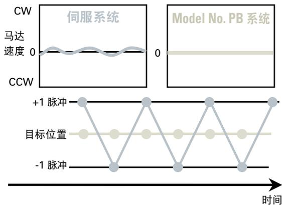
由于步进电机最大静止扭矩的特点，可实现稳定停止。
