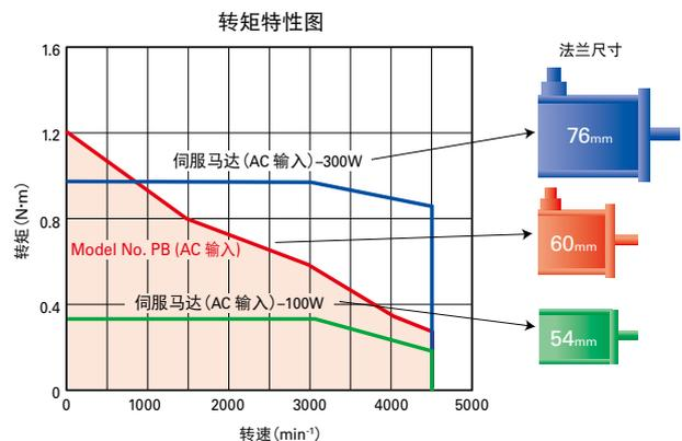
在低速领域与普通的伺服电机相比输出转矩大，有助于缩小系统体积构成 AC 电源输入型的电机转矩比我司以往产品提升了 50%。
