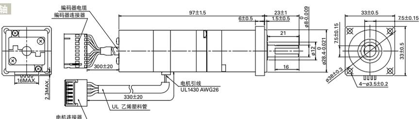
● 带电磁制动器机型
