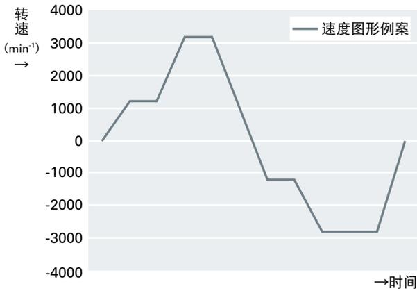
Model No. PB Type R, Type M 内置脉冲发生器功能。从上位装置接收速度、加减速和移动量作为数值数据，然后在驱动器内部按照指令自动生成最合理的速度图形，因此，不需要脉冲发生器。对有效减低系统构成成本。
