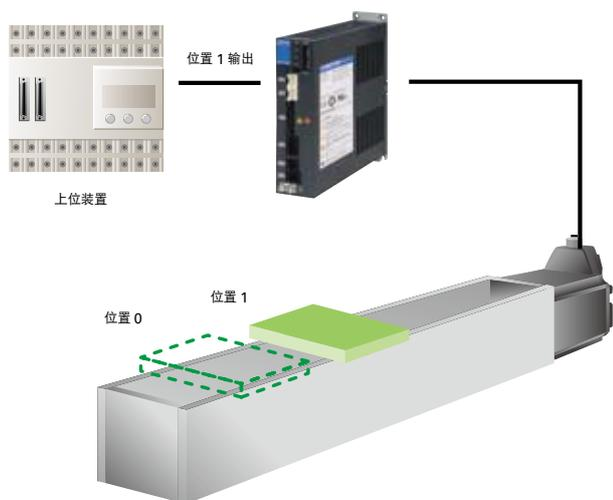
利用通用 I/O 选择预先设定好的位置编号或程序编号，可实现简单的系统控制。（AC Type R，DC Type M128 点，DC Type R 多轴 256 点）
