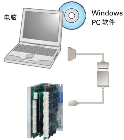
可通过设置软件进行参数的设置，数据编辑以及位置、速度等的监控。
