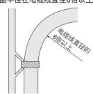
③从电动机连出的电缆线、附属电缆线并不适合弯曲使用。如要弯曲时,请在可动电缆线部位进行弯曲。
