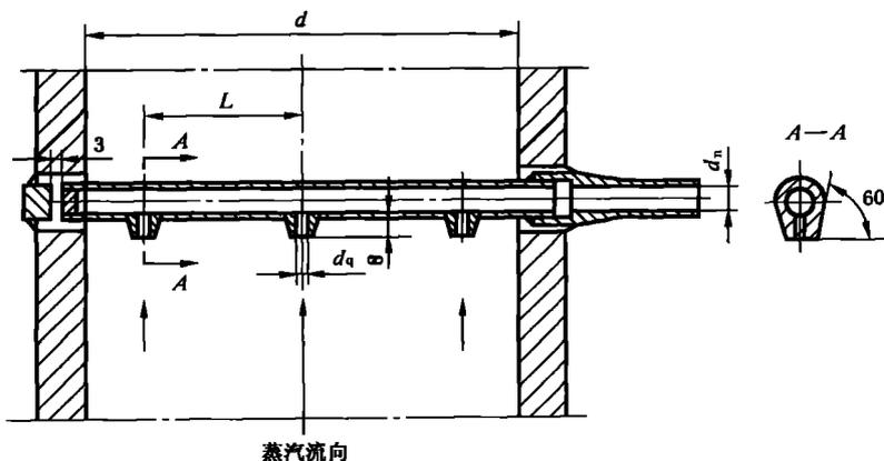
注:  $L \approx 0.433 d$ ;  $d_n = 10 \text{ mm} \sim 15 \text{ mm}$ ;  $d_q$  一般为 3 mm~4 mm。
