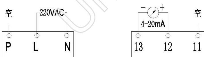
5)、220VAC 供电 4~20mA 输出、带继电器报警输出接线方法:
