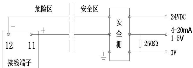
3)、24VDC 供电、4~20mA 输出、带继电器报警输出接线方法:
