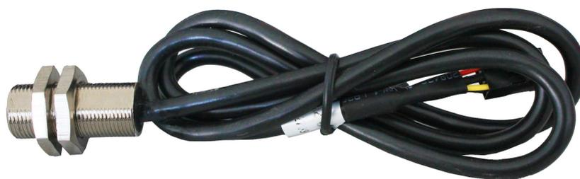
CHCL201 型是一种新型的霍尔齿轮传感器，用于检测速度、角度、转速等。它采用独特的信号处理方式能使传感器与齿轮间的工作间隙达到 3mm 以上，精确的占空比信号输出，工作频率低至 0Hz。
