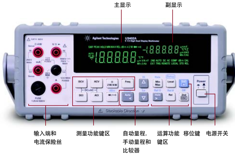
图 1. U3402A 的前面板。U3401A 与其类似，但某些特定功能的位置略有不同。详情请参看 U3401A 用户指南和服务指南 U3401-90001。
