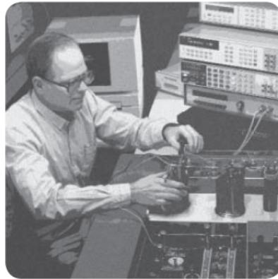
工作于校准实验室的3458A 8.5位数字万用表有卓越的线性度，极低的内部噪声和优异的短期稳定性。3458A 多斜模数转换器的线性度达到当代最高水准。使用阵列 Josephsen 结的本征标准，10V 电压量程的线性度在±0.05 ppm 以内。在1 小时，±0.5°C 条件下，3458A 的10V 电压传递精度达到0.1 ppm。在使用8.5位分辨率时的内部噪声还不到0.01 ppm rms。因此，3458A 是校准用标准数字万用表的正确选择。
