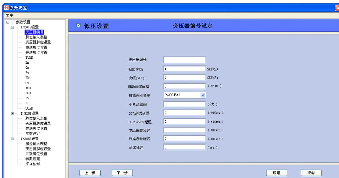
根据所使用的具体被测变压器，设置初、次级等参数。当前变压器共 2 个初级，3 个次级，其他参数依据用户的具体要求而进行相应的设置。
