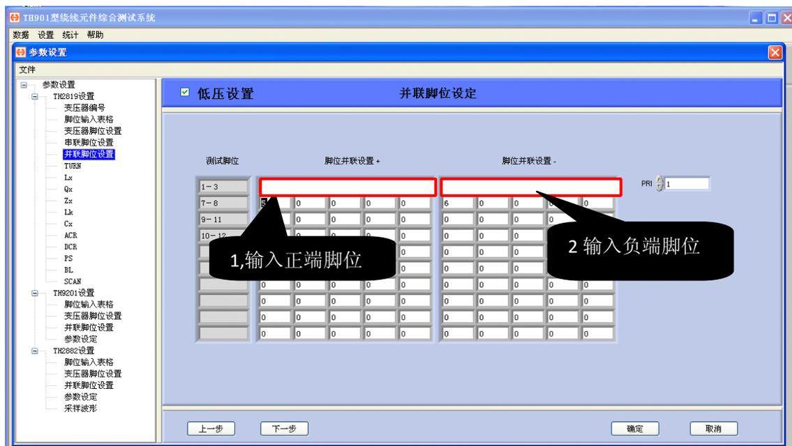
在完成变压器的串、并联脚位设置后，即可针对具体的测试功能，进行针对性的测试参数的设置。TURN、Lx、Qx、Zx、Lk、Cx、ACR、DCR、PS、BL 等十项参数的具体含义请参考仪器 TH2819XA 的说明书。
