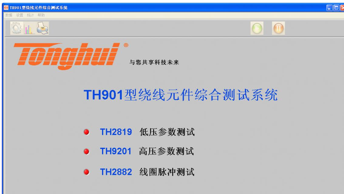
1.5.2 进入开机界面后,系统将自动连接3台下位机 (TH2819, TH9201, TH2822), 如果连接成功将显示绿灯, 并自动进入测试界面, 如下图所示:
