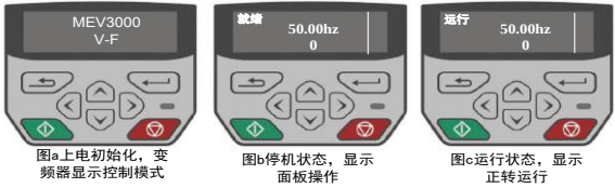
图 4- 2 变频器初始化、停机、运行状态时的显示
