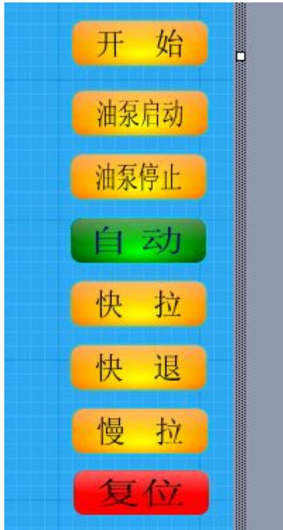
点击油泵启动使油泵启动，点复位再点手动使其变为自动，此时如被测工件连接完好可点击开始进入自动试验状态。试验结束后会自动泄压，
