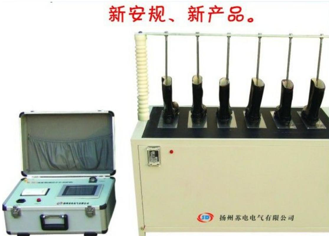
如图，它由试验主机及试验台两大部分组成。当拆开两部分的包装箱后，将试验台固定好，并将主机、放电棒接地线连接好。连接好主机和高压箱的控制线。
