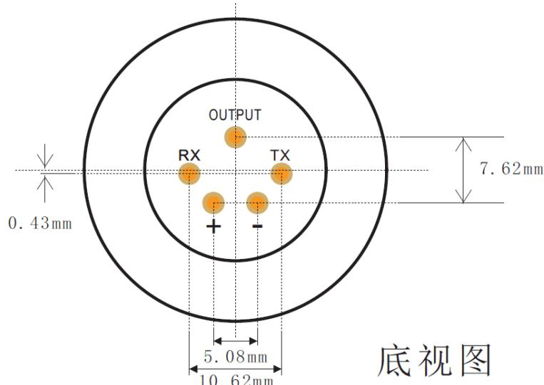
深国安 18 款智能一氧化碳传感器，通常是 5V 供电输出 0-5V 任意电压和 TTL 串口信号。也可以和深国安的信号转换板相结合使用，输出更多可供选择的信号，如 RS485、RS232、USB 转 TTL 串口信号等，用户可以根据要求，选配合适的信号。值得一提的是该款智能型传感器模组是目前市场上体积最小、功能最强大的一款产品。因其出色的性能和可靠性，广泛应用于科研、气体监测等领域。
