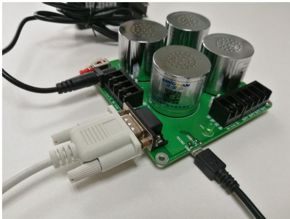
深国安智能型一氧化碳传感器（SGA-700B-CO）具有的特点为产品采用本质安全型电路设计可带电热拔插操作，也兼容红外、电化学、催化、半导体、PID 等不同原理传感器，且深国安出厂的智能传感器任何气体尺寸统一、信号统一、用法统一。
