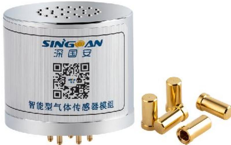
那么功能强大的深国安智能型一氧化碳气体传感器模组（SGA-700B-CO）的工作原理是什么呢？分为几个步骤，先将国外原装进口气体传感器进行信号放大、数据处理、智能计算后，再进行全量程三点温湿度补偿。然后再用 99.999%纯度的标准气体进行数据校准。因此，体积更小、价格更低、性能更加优良稳定；用户购买后，无需任何操作，无需再次标定，可直接采集处理后的标准信号（0-5V 之间任意电压和 TTL 数字信号），上传到控制主机、PLC、DCS、DDC 等系统上；方便快捷、节约成本；因其卓越性能和独特技术优势，受到客户的普遍认可；产品广泛应用于科研、数据采集、气体监测、过程化控制、物联网、无人机、工业机器人、网格化大气环境监测仪、微型空气质量监测站等领域。
