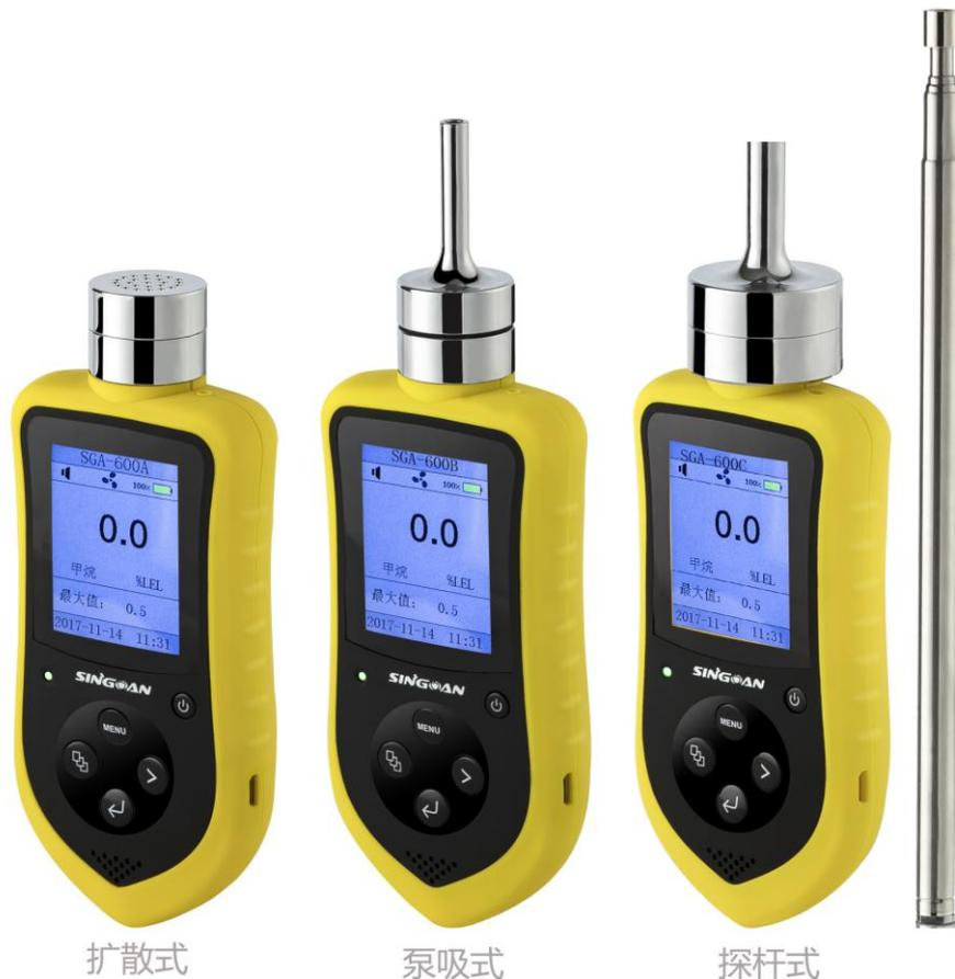
气体检测仪带泵，说明气体检测的采样方式为泵吸式。而泵吸式的采样方式，可根据实际要求来使用。对很多检测场所来说，只有泵吸的采样方式，突出的检测效果才更好。
