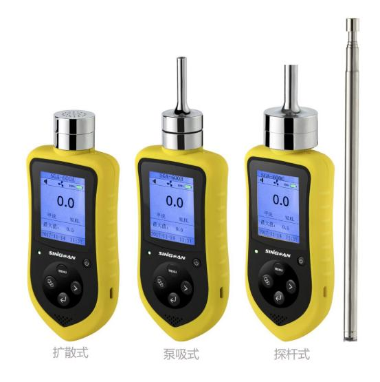
深国安便携式气体报警器也有三种采样方式: 扩散式、泵吸式、探杆式。针对不同项目选用不同采样方式。
