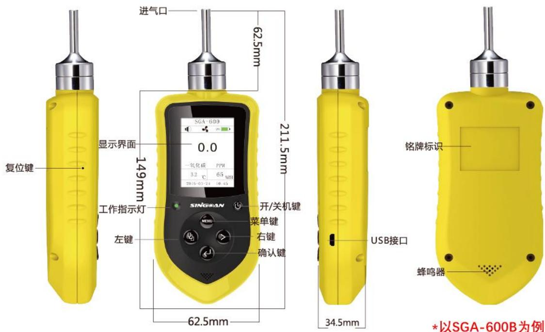
根据用户行业习惯和标准的不同，深国安便携式气体检测仪还可以进行 PPM 与 mg/m<sup>3</sup> 量程单位自由切换和中文简体、中文繁体、英文操作界面，适用所有人群；还可选配数据存储功能，轻松存储 100,000 条数据。支持本机查看所有保存的历史数据、开关机纪录、报警纪录、故障纪录等；并可通过电脑将数据导出 EXCEL 表格，进行打印、编辑、图表显示等；可以说，深国安便携式二氧化氯检测仪是当前国内最先进、最智能的一款气体检测仪表产品。
