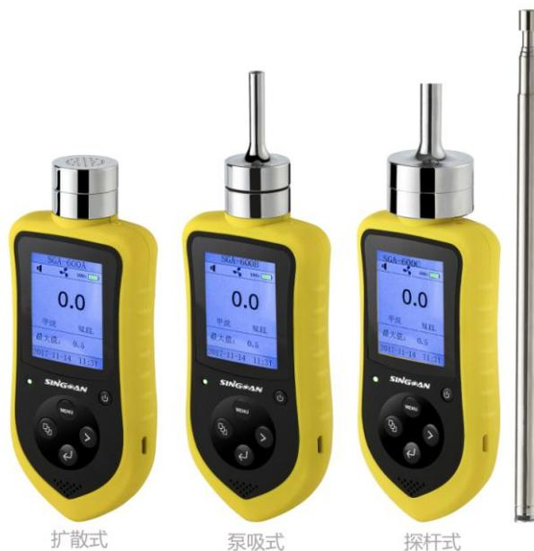
深国安便携探杆式氯化氢检测仪，配置有 1M 长的自由伸缩杆。用户在需要时，可将伸缩杆拉长，这样就可以对很多人不方便进去或者较高或较低处残留的氯化氢气体进行检测。
