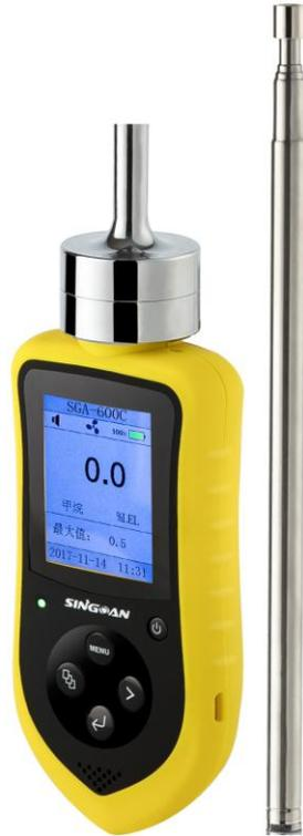
氯化氢常规检测量程为 0-50ppm，也就是说在室内空气中氯化氢气体达到 50ppm 时是比较危险的。所以在检测现场安装的氯化氢检测仪一般要在 10ppm 左右就要进行报警了。报警后也方便相关人员进行应急措施，这也是因为氯化氢浓度太高容易给人造成危害，所以需要防范于未然，及时做好安全措施。
