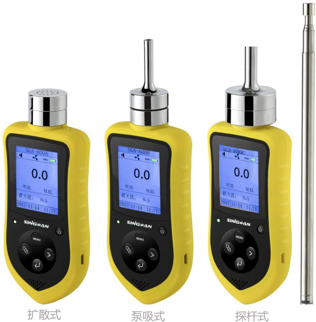
便携扩散式六氟化硫检测仪通过气体的流动来进行采样。当六氟化硫气体进行到检测仪气室中时，便可实现检测。无须添加任何的化学物质，即可快速实现检测。
