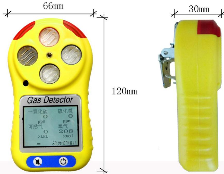
四合一气体检测常规检测量程为可燃气体 0-100%LEL、氧气 0-30%VOL、一氧化碳 0-1000ppm、硫化氢 0-100ppm。说明这些气体在不超标的情况下（氧气是不超标和含量过低），人可以自由的在检测场所中活动。当四合一检测仪发生报警时，则需要及时采取安全防护措施，特别是硫化氢、一氧化碳、可燃气体的超标。
