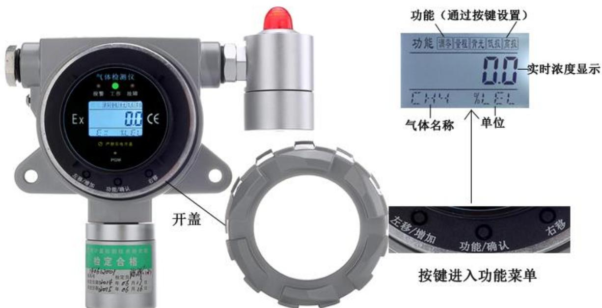
深国安甲烷检测仪主要采用原装进口气体传感器，其原始传感器经过深国安二次开发后形成，具有高精度、稳定性强等特点。由于甲烷气体的易燃易爆性，所以深国安甲烷气体检测仪配置了铝合金防爆外壳且采用本质安全型电路设计，把可能源于甲烷检测仪的着火点给消灭，这样可使甲烷检测仪安全的安装在检测现场中。
