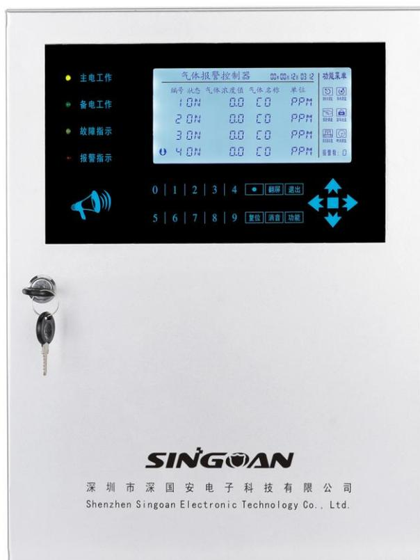
根据甲烷易燃易爆的特点，很多时候甲烷检测仪都是配合深国安报警控制器来使用。报警控制器除了可以给甲烷检测仪供电外；还方便统一进行管理；另外，通过报警控制器也可以对电磁阀、风机、喷淋系统等进行相关联动，气体超标报警时，报警控制器内的开关量信号信号也会自动启动/关闭电磁阀、风机、喷淋系统等设备。提高安全指数，做到万无一失。
