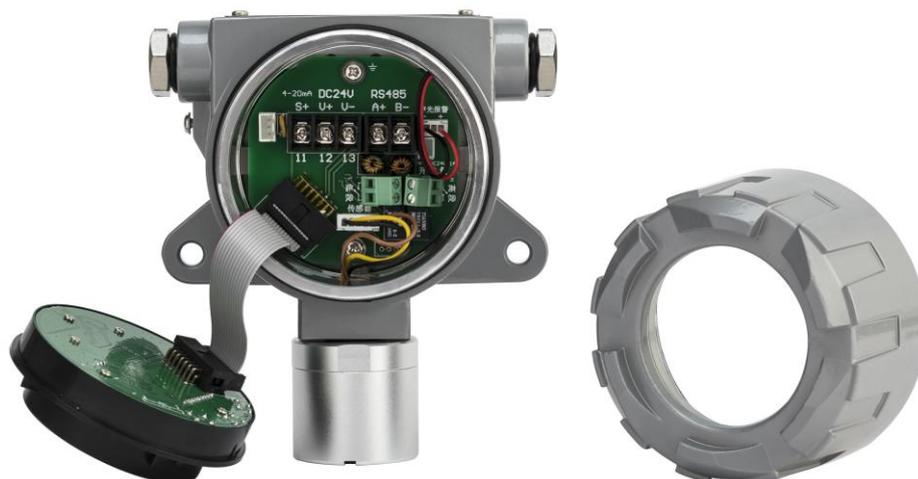
甲烷检测仪怎么接线这个问题，这样要看用户选择的是几线制的甲烷检测仪，根据相关提示完成接线即可。如二线制甲烷检测仪单机使用，只需要接电源正、电源负即可（红色线接检测仪电源正、白色线接检测仪电源负）。
