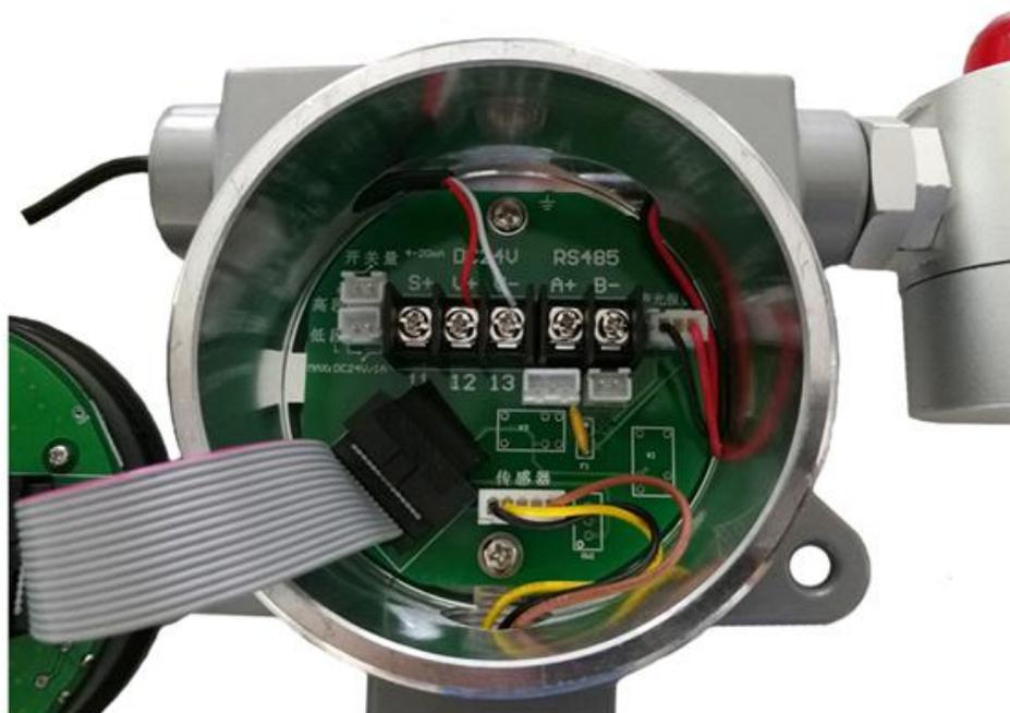
关于甲烷检测仪怎么安装这个问题，这个都是根据气体的分子量或蒸汽比重来决定的。甲烷气体分子量约为 16，比空气轻，所以，在线式甲烷检测仪的安装位置一般则为泄漏源上方的 30-50cm 处。
