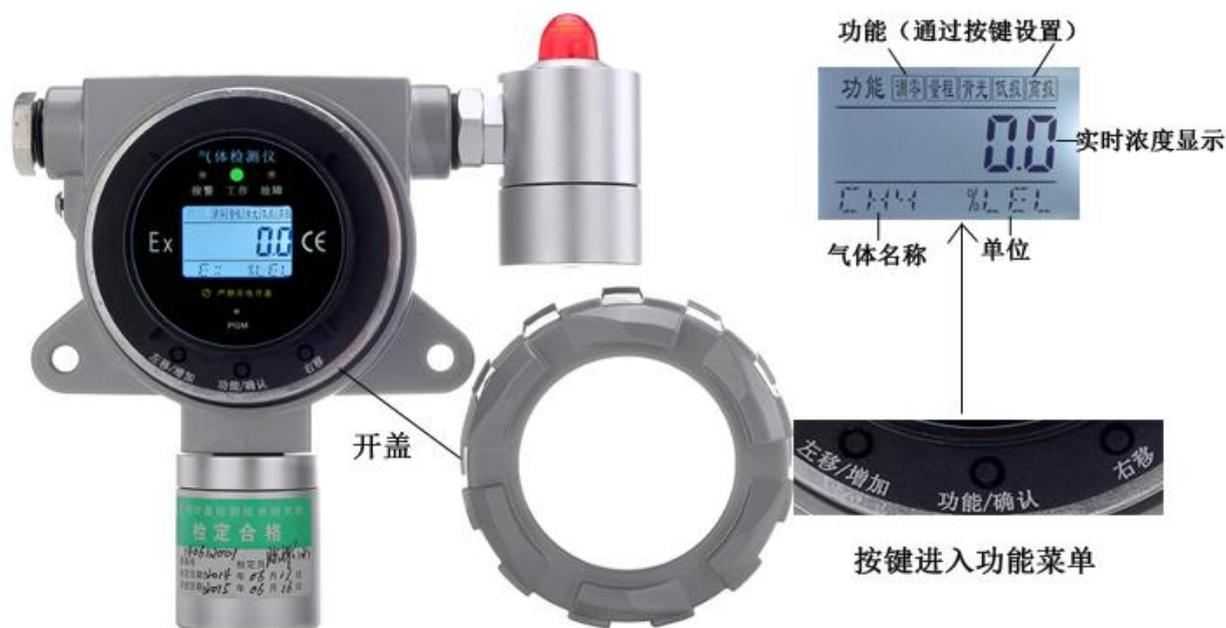
深国安氟利昂检测仪采用原装进口气体传感器，该原始传感器由于不能直接使用，在经过深国安二次开发后可以直接使用。除了可以直接供电使用外，还可以直接采集 4-20mA、RS485 信号；氟利昂智能传感器模组则可以 5V 供电，直接采集 0-5V 电压、TTL 串口信号等。氟利昂智能传感器模组配套深国安信号转换板，则可以输出 4-20mA、RS485、USB 转 TTL 串口信号等，用户根据自身的需要进行选择和采集。
