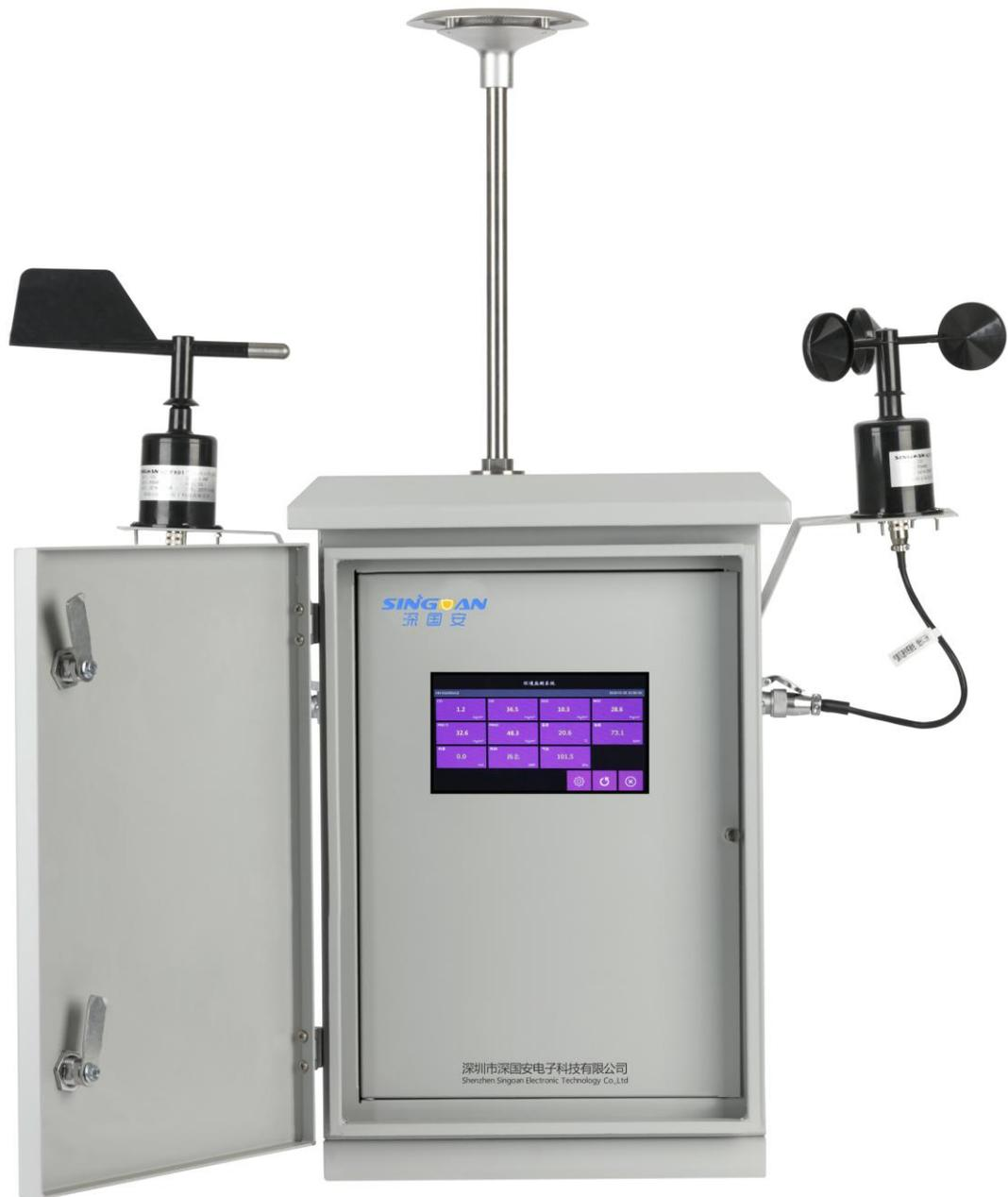
那么实现 PM2.5、PM10 监测，智能传感器的工作原理又是什么呢？其实是通过工作原理粒子经过聚焦激光所形成的光敏感区后，粒子散射的光被探测窗口上的微光电探测器收集，微光电探测器把接收的光强度信号快速、准确的转化为等量电压信号，信号的密集度对应于粒子
