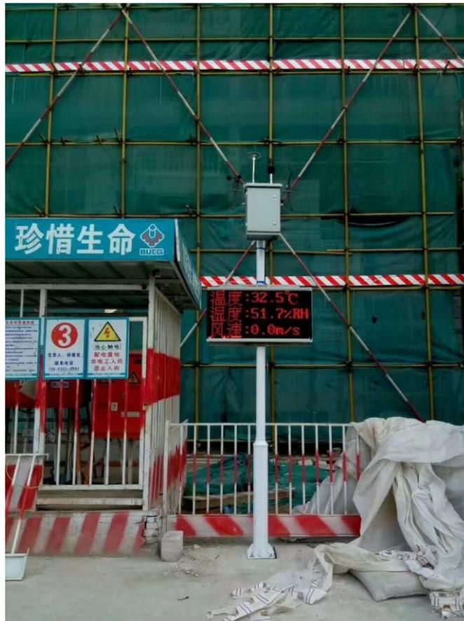
当然，大气监测的其他数据也可以通过内置大屏幕触摸屏进行显示，用户需要在监测中心、系统后台等进行显示存储的，也可以通过内置的无线传输模块，通过 GPRS 数据远传，简单快捷，方便实现大范围监测布点。
