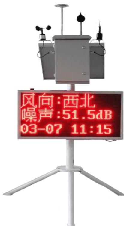
大气监测中，四气两尘常规默认监测量程是一氧化碳（0-20ppm）、二氧化硫（0-1ppm）、二氧化氮（0-1ppm）、臭氧（0-1ppm）、PM2.5（0-1000ug/m<sup>3</sup>）PM10（0-2000 ug/m<sup>3</sup>）。
