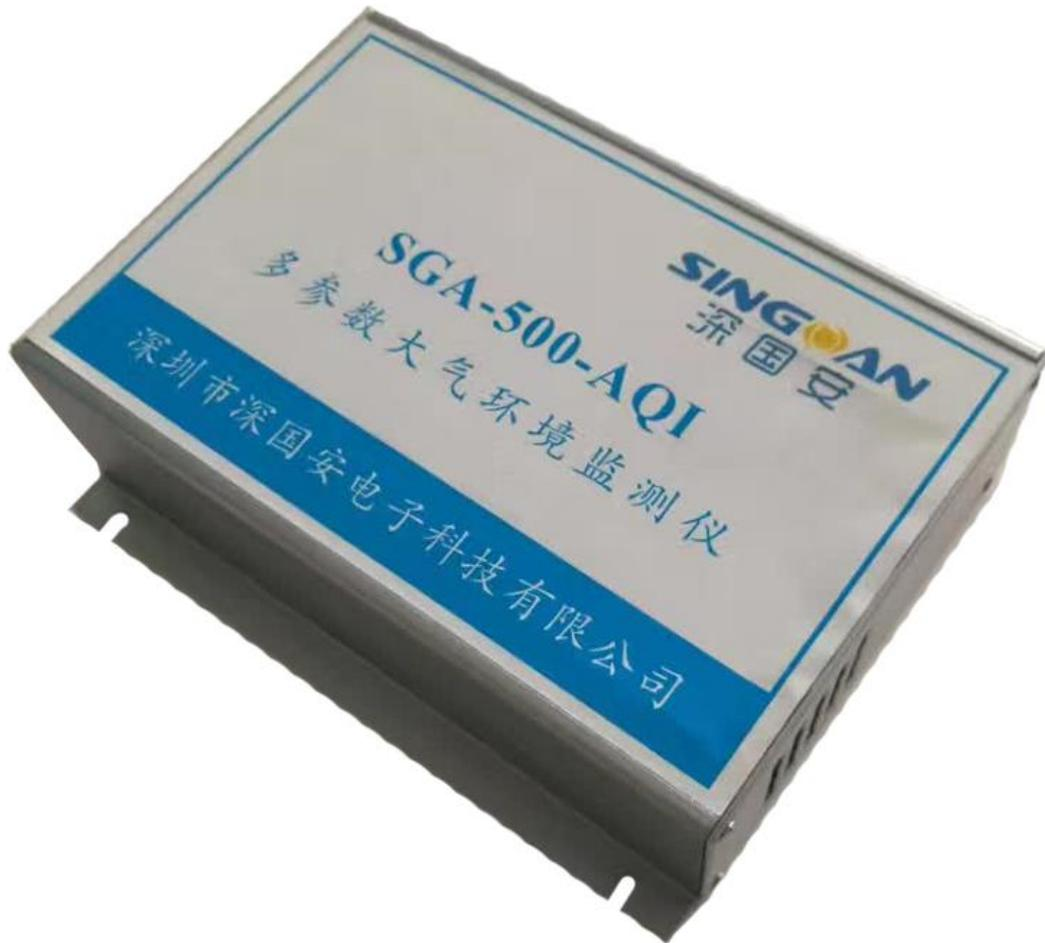
而我们大气监测仪中 PM2.5、PM10 利用激光散射法测量颗粒物浓度来对 PM2.5、PM10 进行监测。通过用精密流量控制的吸气真空泵，将空气中的气体吸入大气监测仪中，当气体进入到智能传感器测量组件，其监测数值会通过数字信号来表达。
