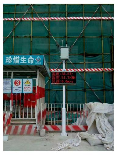
扬尘检测仪的运用,主要在空气质量监测、工地扬尘监测、大气环境 监测等方面。扬尘监测主要是监测四气两尘、温湿度、风速、风向、 大气压,噪音等。常规四气两尘是监测最多的,包括一氧化碳、二氧 化硫、二氧化氮、臭氧、PM2.5、PM10等。
