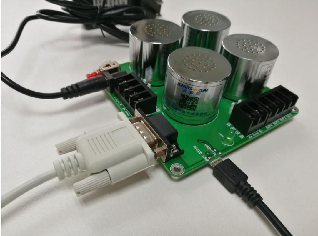
深国安氮氧化物检测仪，核心传感器同样采用进口气体传感器。经二次开发后，可以直接采集标准 RS485、4-20mA 信号，也可以 RS485、4-20mA 双信号同时输出。用户可以根据自己的系统来进行相关采集。
